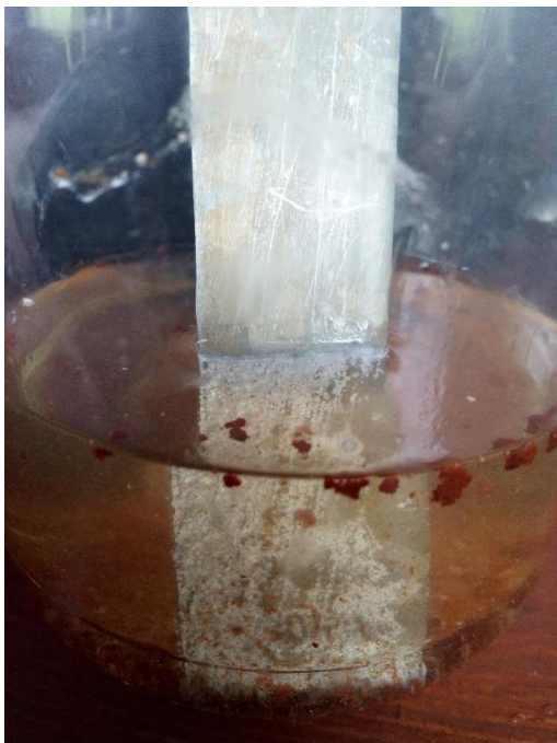
Příloha VI: obrázek kovového plíšku v roztoku chlornanu sodného po skončení reakce
