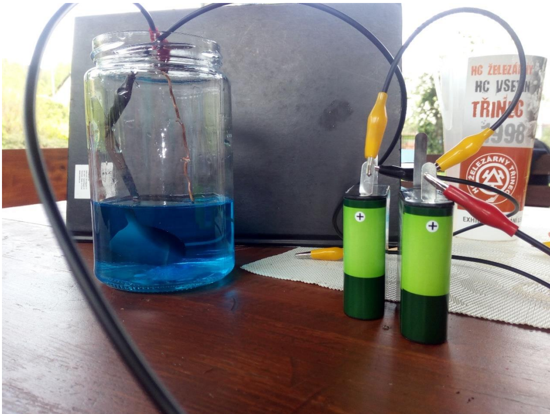
Příloha X: obrázek aparatury pro galvanizaci
