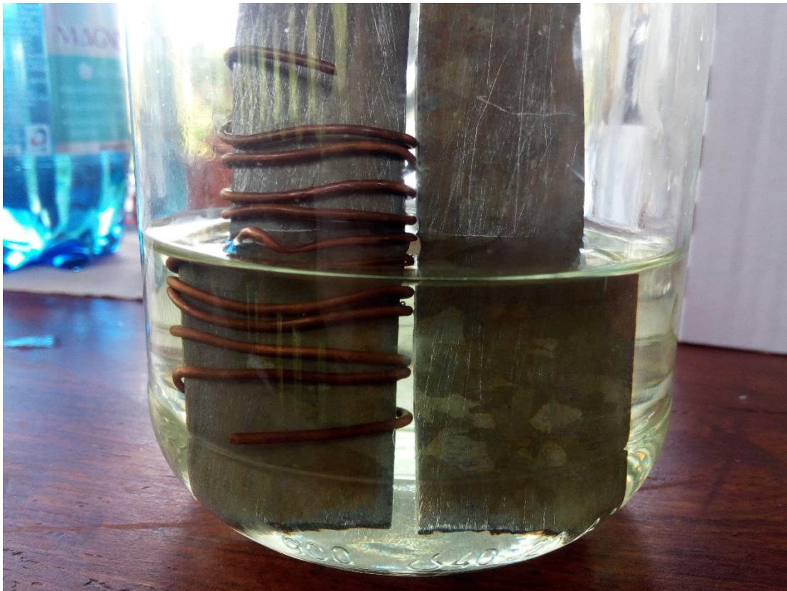
Příloha V: obrázek kovových plíšků v roztoku chlornanu sodného na začátku reakce
