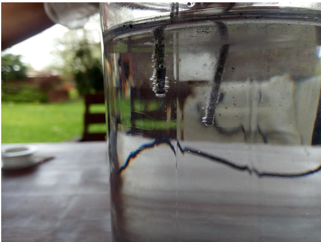
Příloha XIII: obrázek probíhajících reakcí na elektrodách (vlevo anoda, vpravo katoda)
