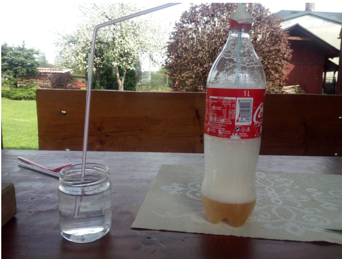
Příloha IV: obrázek aparatury pro přípravu CO 2 a reakce octa s jedlou sodou
