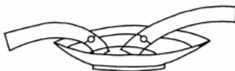
Obr. č. 3: Schéma rozložení papírů pro chromatografii na papíře (Macenauerová, 2006).
