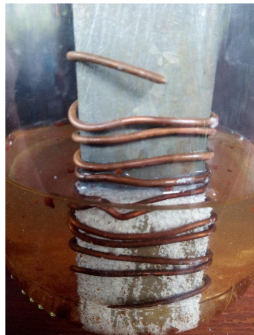
Příloha VII: obrázek kovového plíšku s měděným drátem v roztoku chlornanu sodného po skončení reakce
