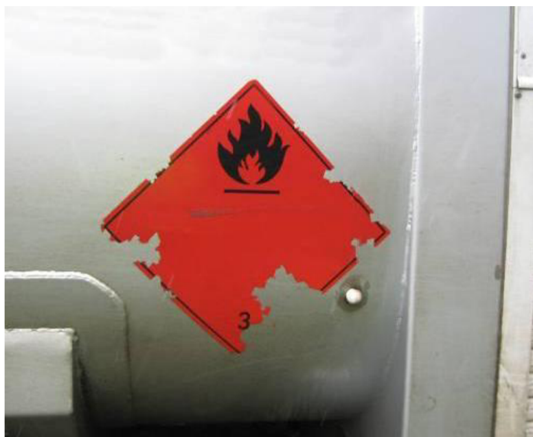
Obrázek 8.3 Poškozená bezpečnostní značka[61]
