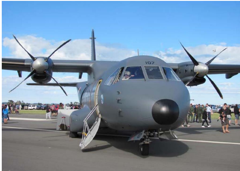
Obr. 1.14: Příklad vrtule nastavené do praporu na letounu CASA CN 235 [8].
