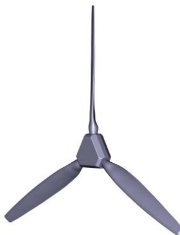
Obr. 4.4: Model vrtule s trojúhelníkovým uložením dle statického testu.
