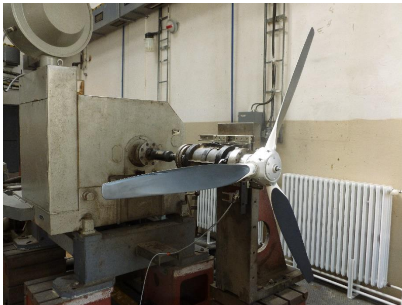
Obr. 4.2: Vrtule P1 PowerMax při statické zkoušce v tlačném uspořádání.
