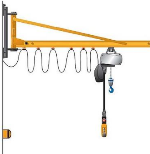
Obr. č. 10 - Konzolový otočný jeřáb [23]
