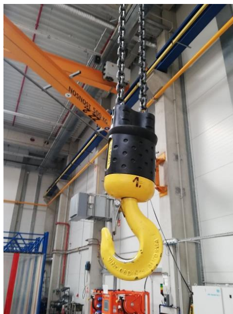
Obr. č. 7 - Háček součástí jednonosíkové kočky [Vlastní]
