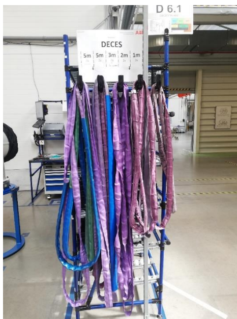
Obr. č. 8 - Vázací popruhy fialové 1 000 kg [Vlastní]
