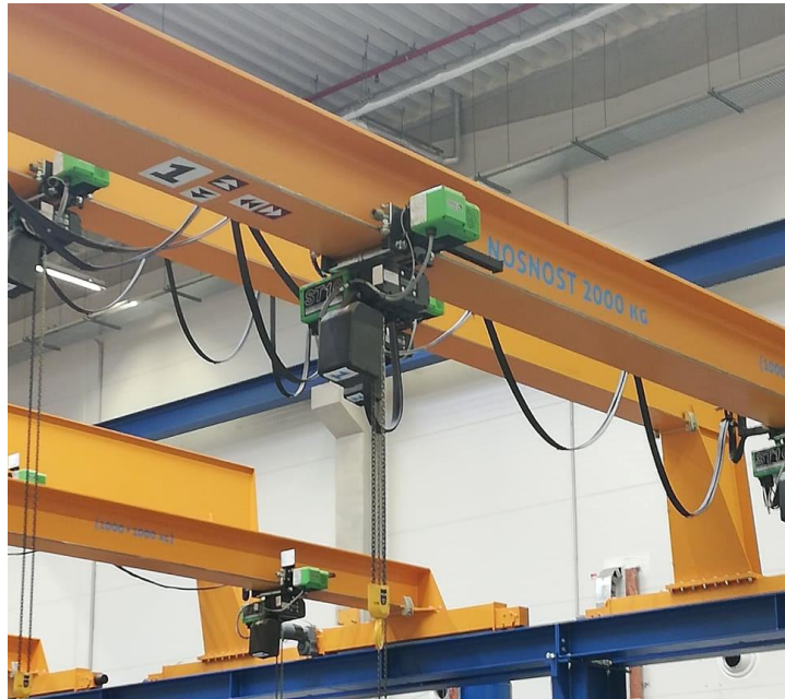
Obr. č. 6 - Jednonosíková kočka [Vlastní]
