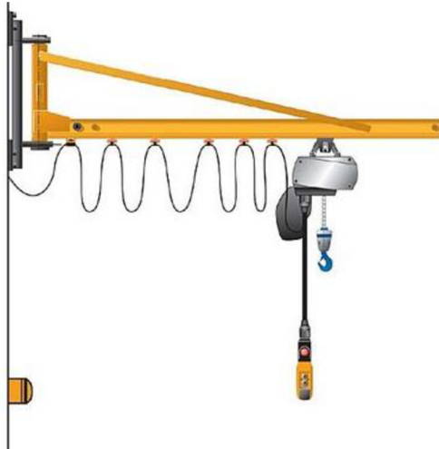
Obr. č. 10 - Konzolový otočný jeřáb [23]
