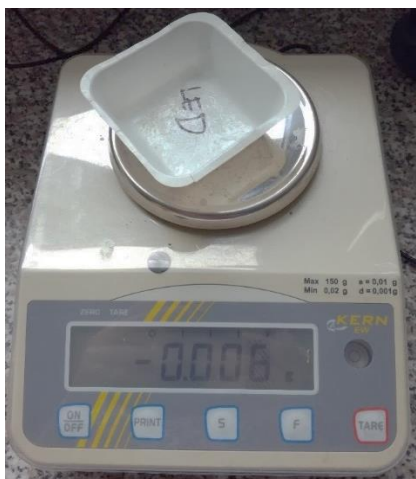
Obrázek 5: Laboratorní váhy Kern EW 150 – 3M (zdroj: autor práce).
