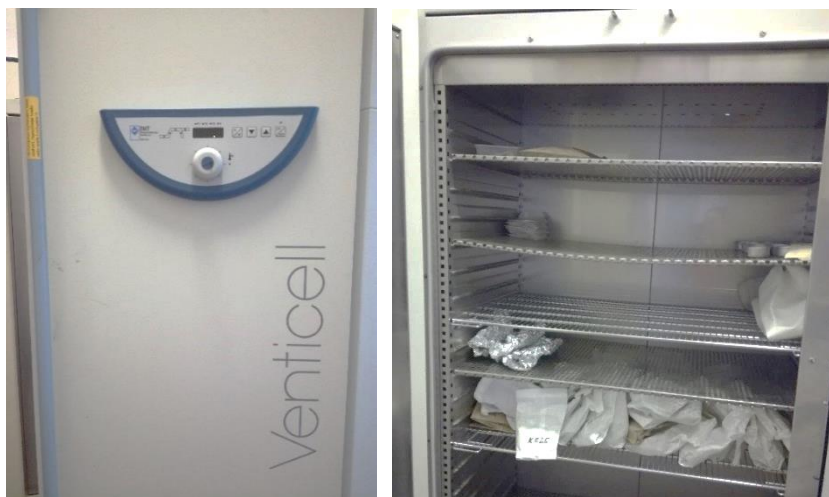
Obrázek 10 a Obrázek 11: Sušárna Venticell 707 (zdroj: autor práce).
