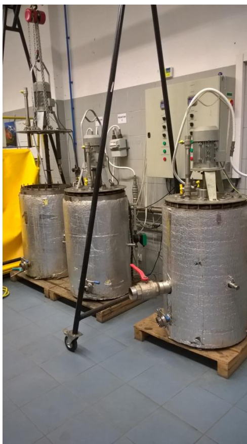
Obrázek 2: Fermentory o objemu 0,120 \text{ m}^3
