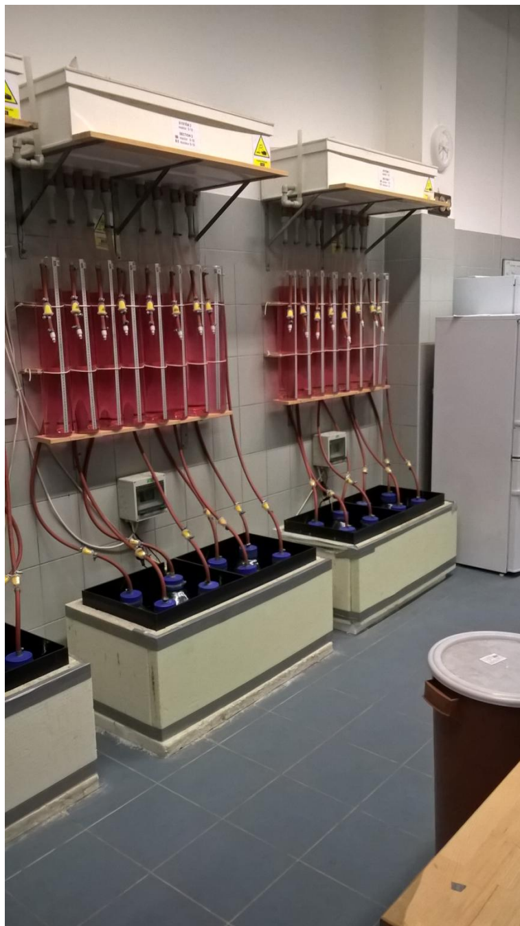
Obrázek 3: Fermentory o objemu 0,005 m 3
