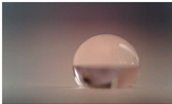
Obr. 6 Voda na hydrofobizovaném zdícím prvku silan-siloxanovou mikroemulzí
