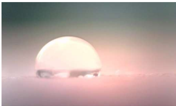
Obr. 5 Voda na nehydrofobizovaném zdícím prvku
