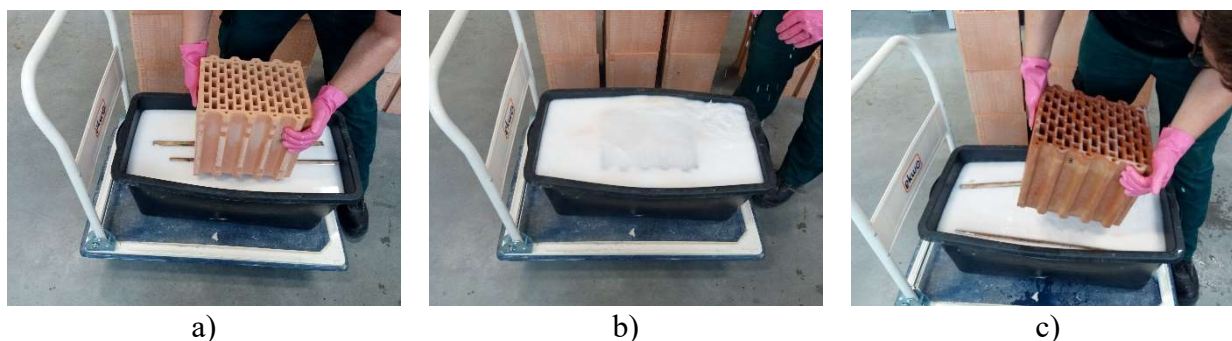
Obr. 1 Aplikace hydrofobizačního přípravku máčením; a) zdící prvek před hydrofobizací; b) zdící prvek v hydrofobizačním roztoku; c) zdící prvek po hydrofobizaci
