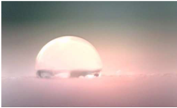
Obr. 5 Voda na nehydrofobizovaném zdícím prvku
