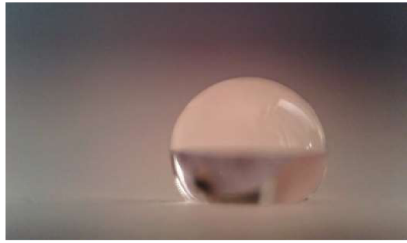
Obr. 6 Voda na hydrofobizovaném zdícím prvku silan-siloxanovou mikroemulzí
