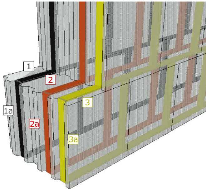
Obr. 2 Návrh aplikace pojiva pro zdící systém do oblastí se zvýšeným rizikem záplav (pruh pojiva: 1 a 2 – poloha pojiva ložné spáře přibližně ve třetině tloušťky zdiva; 3 – pruh pojiva navíc v místě předpokládaného zvýšeného hydrofyzikálního namáhání; 1a, 2a a 3a – pruh pojiva v oblasti styčné spáry navazující na pojivo v ložných spárách)
