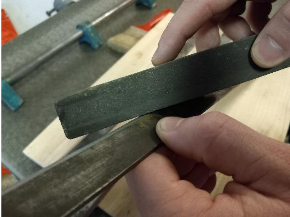
Obrázek 31 Ruční přebroušení hoblovacího nože (foto autor)
