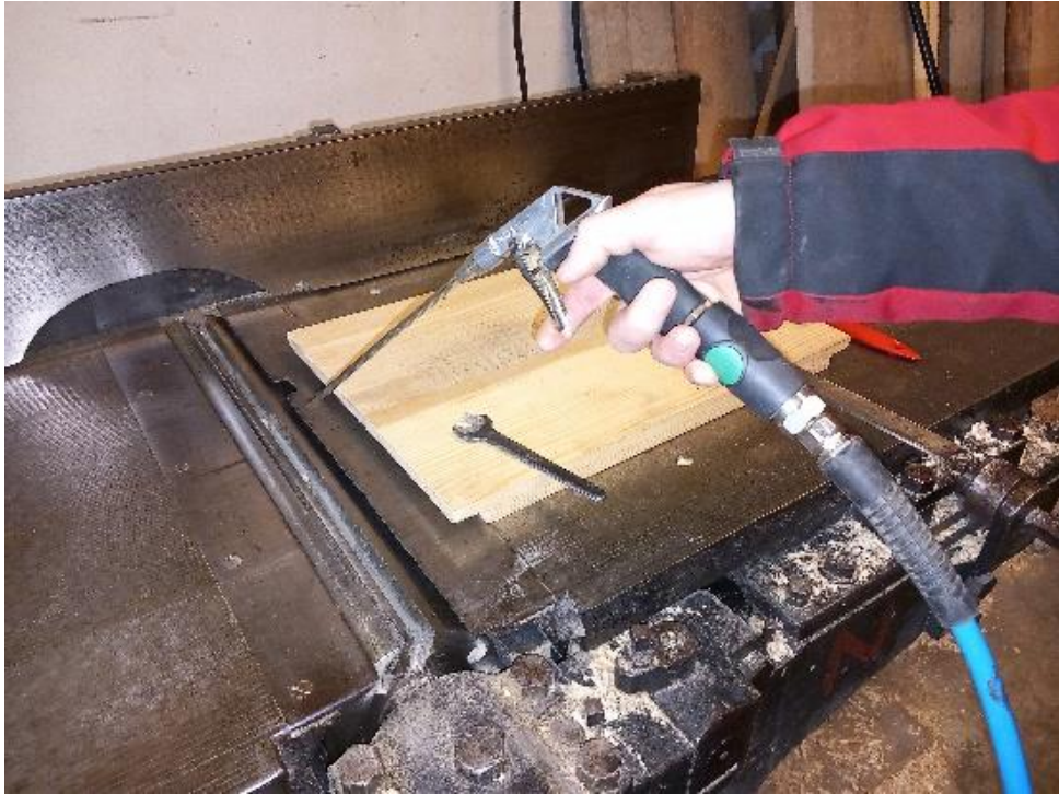
Obrázek 24 Čištění stlačeným vzduchem (foto autor)
