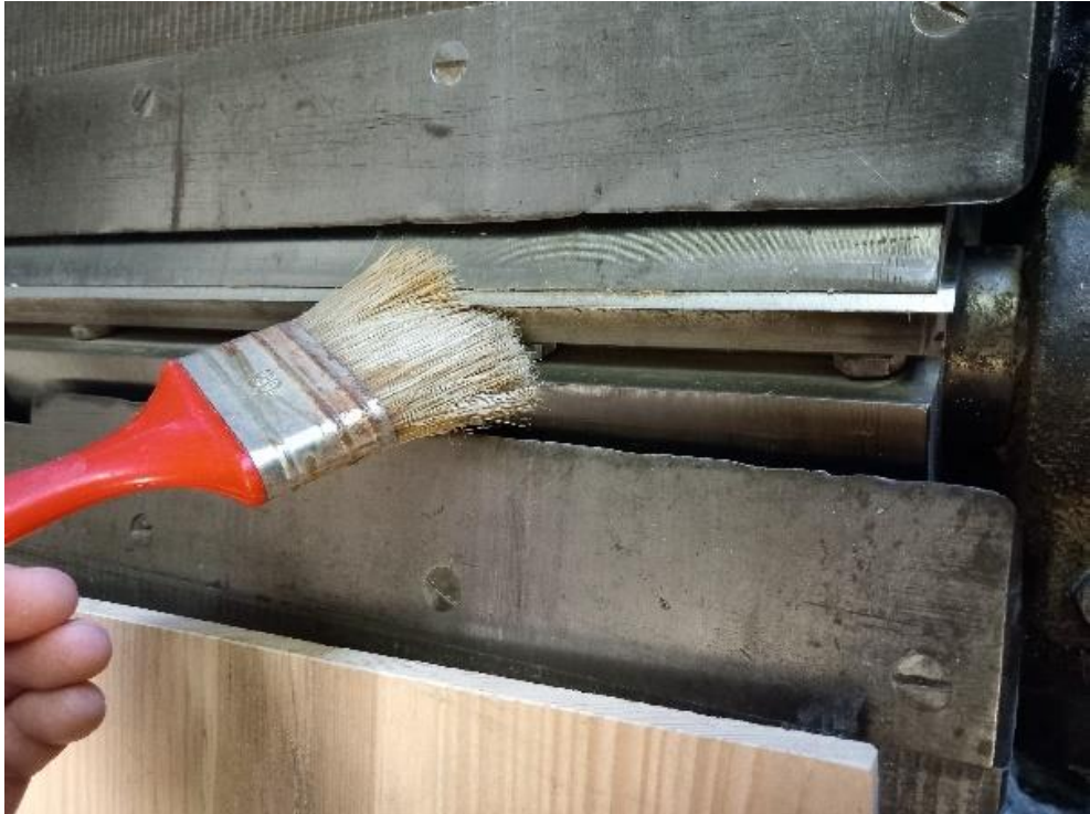
Obrázek 28 Čištění hoblovacího válce (foto autor)
