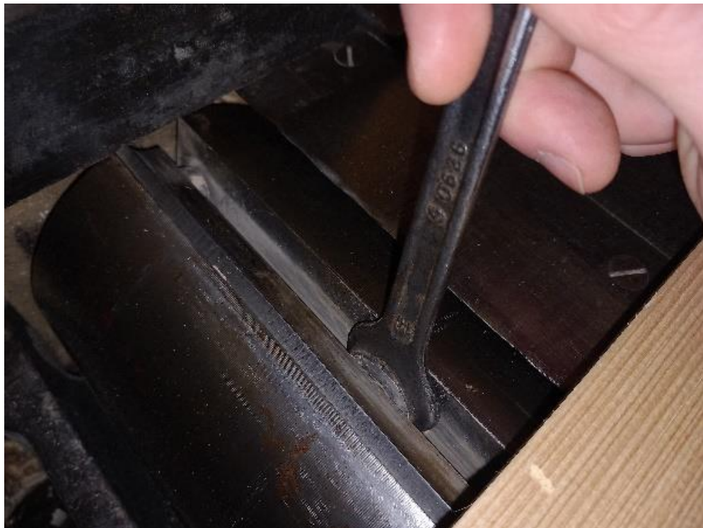
Obrázek 34 Upevňování hoblovacího nože po usazení (foto autor)
