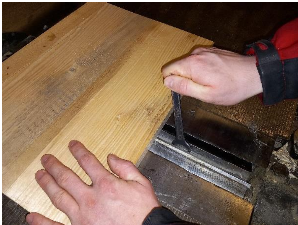
Obrázek 30 Uvolnění hoblovacího nože s bezpečnostním prvkem (foto autor)
