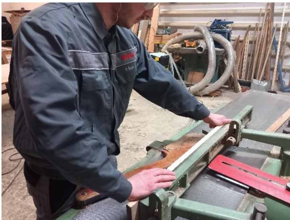
Obrázek 21 Bezpečnostní prvky na srovnávací frézce (foto autor)
