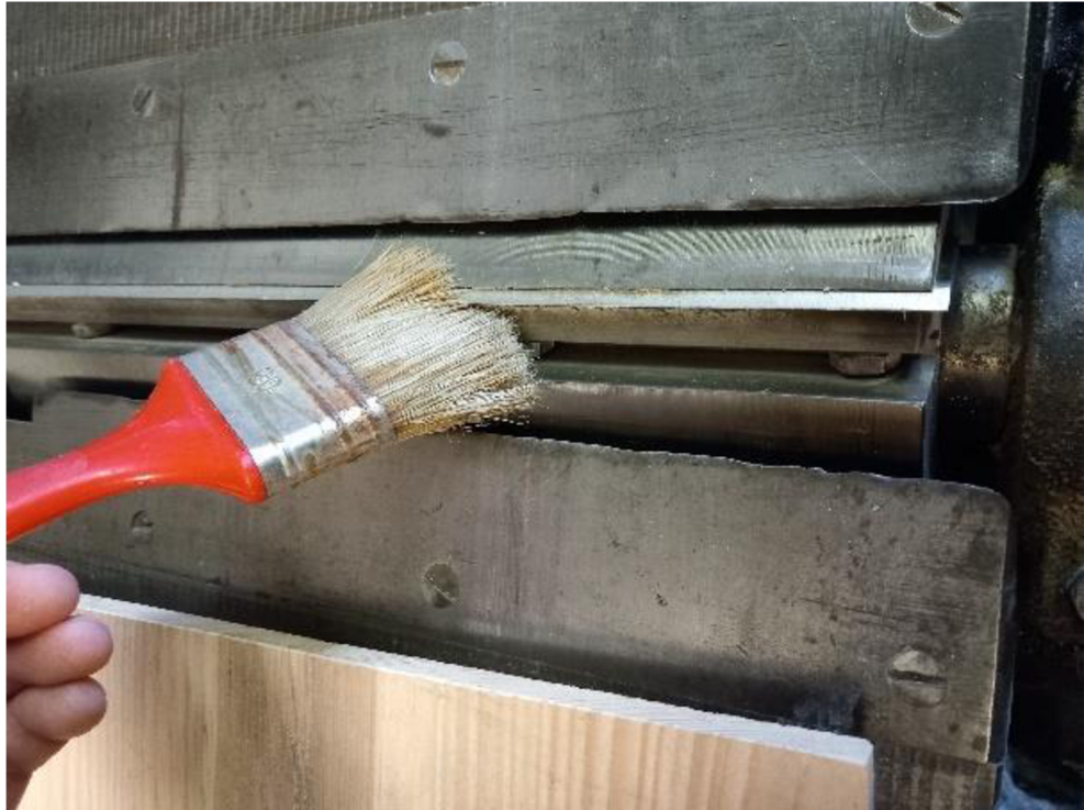
Obrázek 28 Čištění hoblovacího válce (foto autor)
