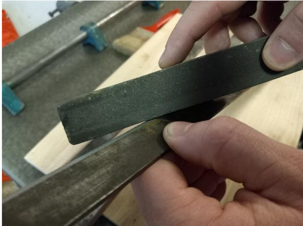
Obrázek 31 Ruční přebroušení hoblovacího nože (foto autor)
