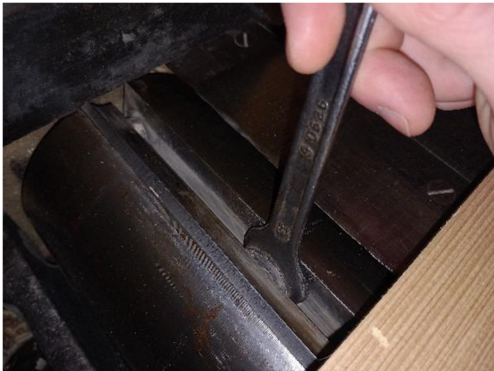
Obrázek 34 Upevňování hoblovacího nože po usazení (foto autor)
