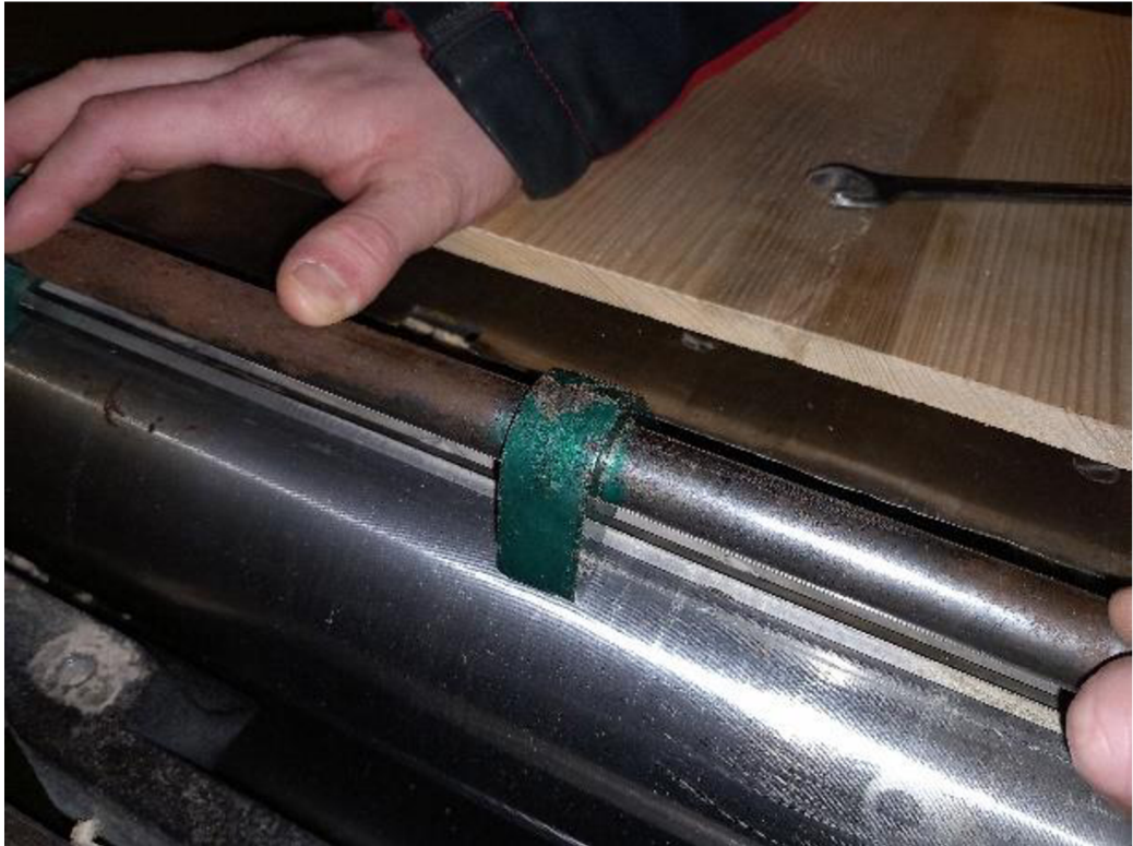
Obrázek 32 Usazení hoblovacího nože s pomocí segmentu (foto autor)
