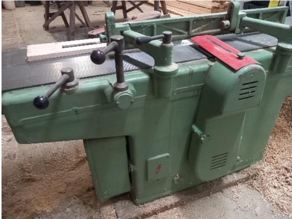
Obrázek 19 Orovnávací frézka (foto autor)
