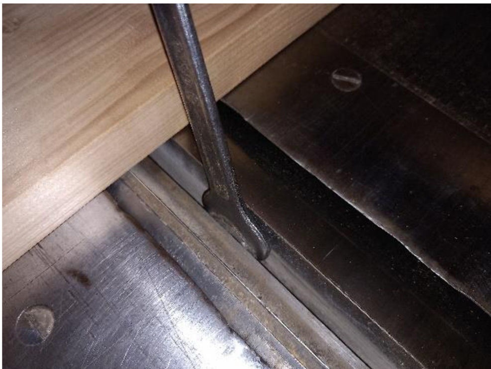
Obrázek 29 Uvolnění upínacího zařízení (foto autor)
