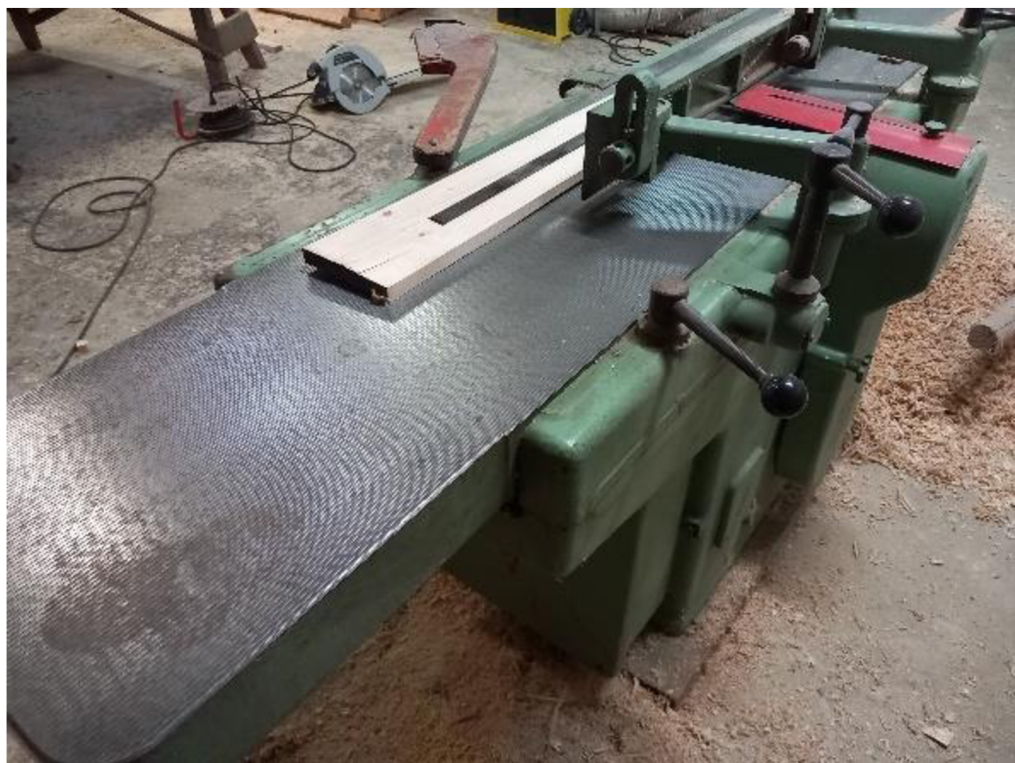
Obrázek 20 Pracovní stůl a pravitko orovnávací frézky (foto autor)
