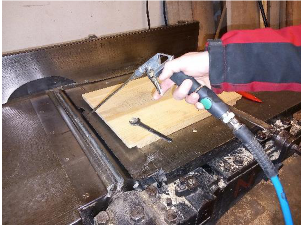
Obrázek 24 Čištění stlačeným vzduchem (foto autor)
