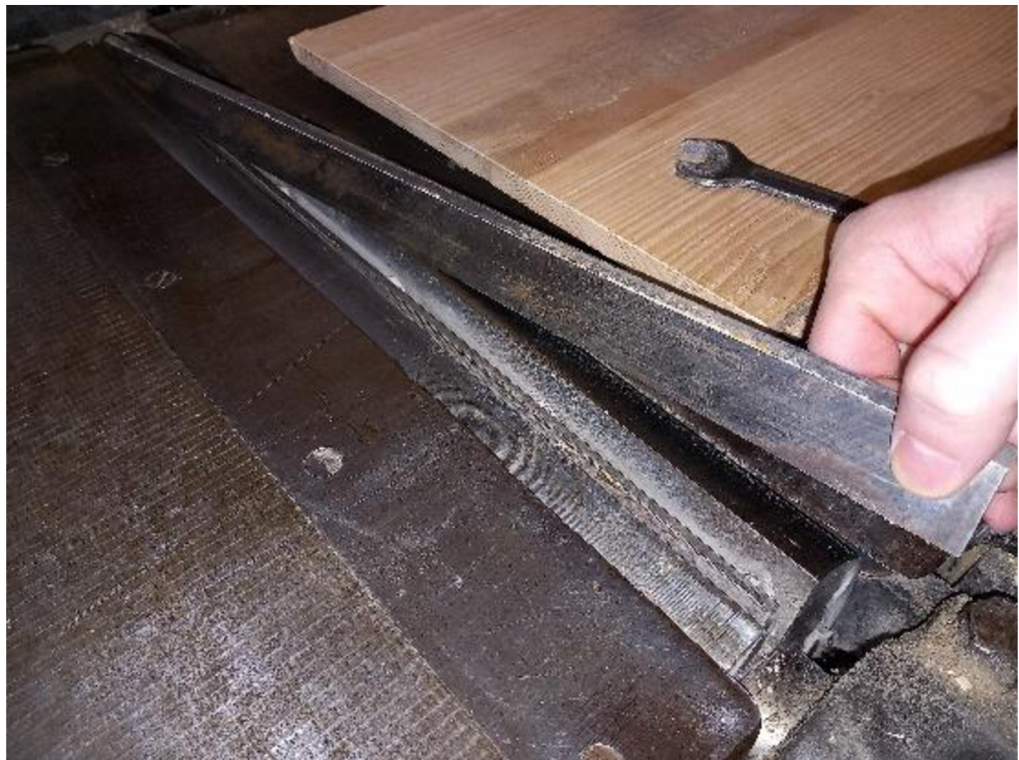
Obrázek 27 Výmuti hoblovacího nože (foto autor)
