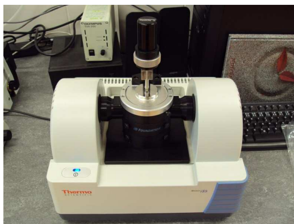
Obrázek 3.3: Nicolet iS5 FT-IR Spektrometr
