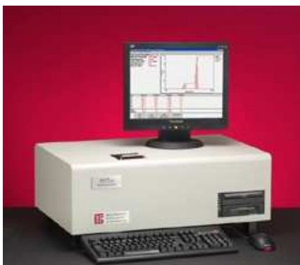
Obrázek 3.1: Brookhaven 90Plus Particle Size Analyzer 52
