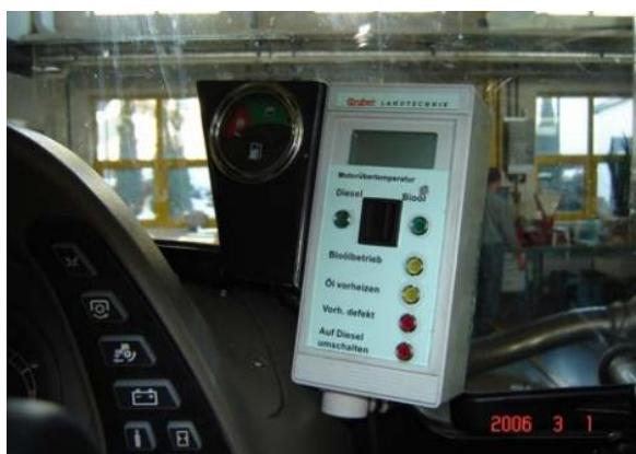
Obr. 5 Ovládací a informační panel použitý u dvoupalivového systému traktoru Case IH 135 MXU
