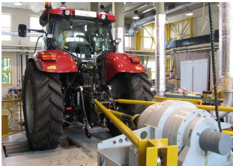
Obr. 6 Měření vlivu paliva na výkon motoru s Common Rail
