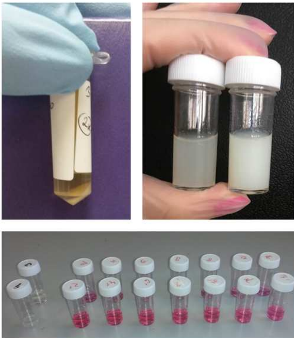
Obrázek 23: Příprava liposomové suspenze pro testování cytotoxicity. Vlevo nahoře: peleta liposomů po centrifugaci; vpravo nahoře: porovnání liposomové (vlevo) a PHB liposomové suspenze (vpravo); dole: koncentrační řada liposomové suspenze ředěné kultivačním médiem
