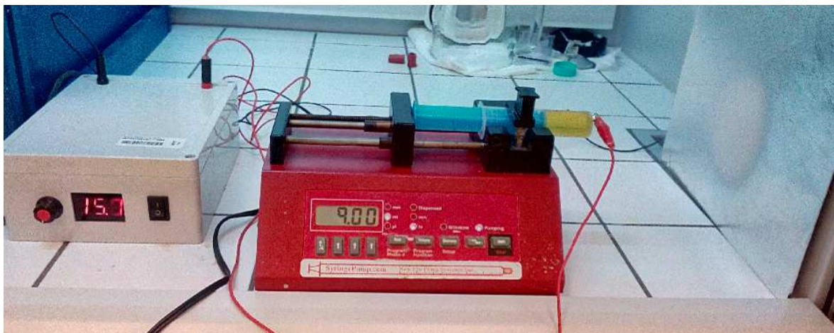
Obrázek 16: Elektrospinningová soustava FCH VUT v Brně
