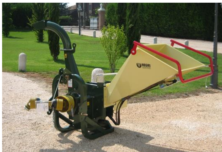
Obr. 32 Drtič Negri bio R225T s třibodovým závěsem [35]
