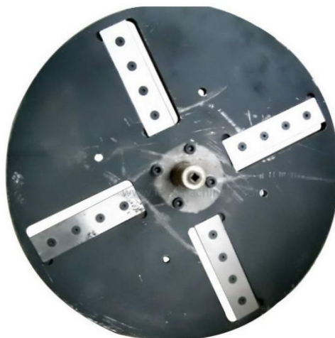
Obr. 15 Nožová hlava BXRFF s roztečí nožů 45° [14]
