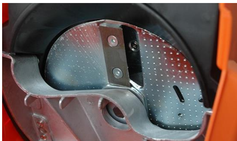
Obr. 3 Diskový sekací mechanismus s vyměnitelnými noži [3]
