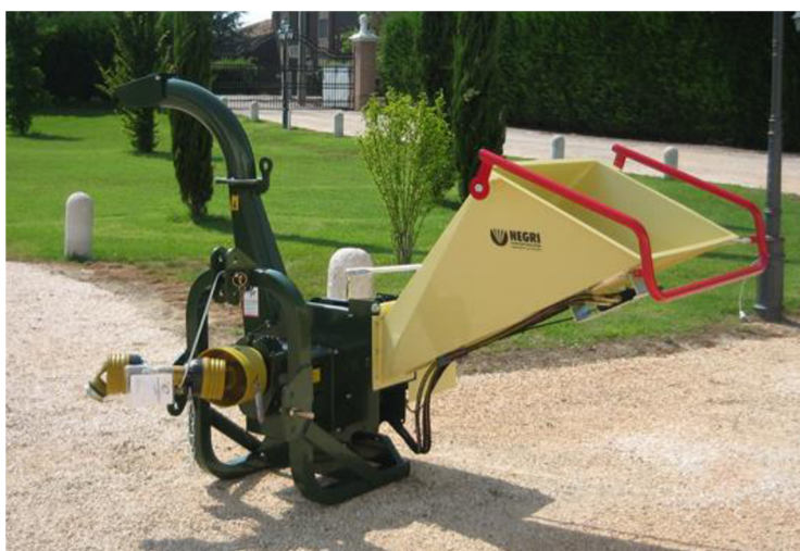
Obr. 32 Drtič Negri bio R225T s třibodovým závěsem [35]
