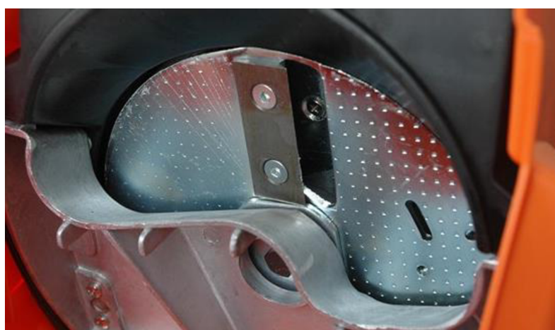
Obr. 3 Diskový sekací mechanismus s vyměnitelnými noži [3]
