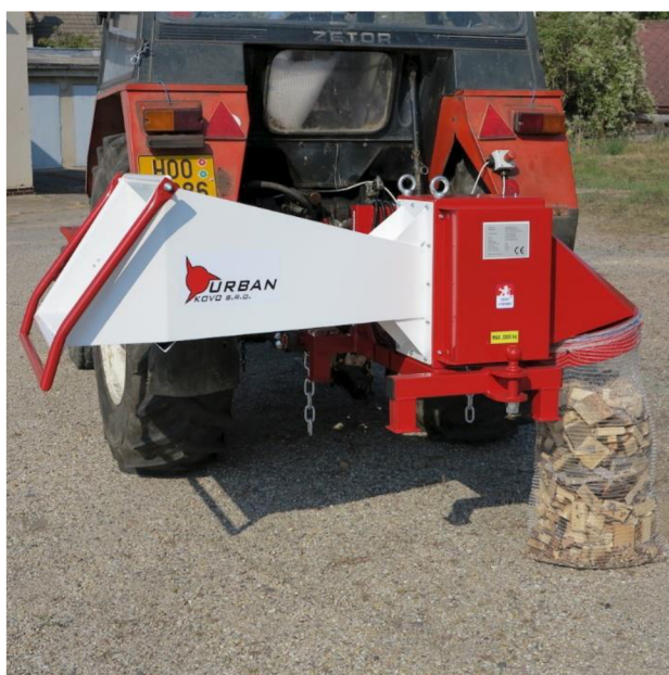
Obr. 22 Štěpkovač URBAN TR70 s jednoduchým pytlovačem [22]
