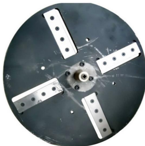
Obr. 15 Nožová hlava BXRFF s roztečí nožů 45° [14]
