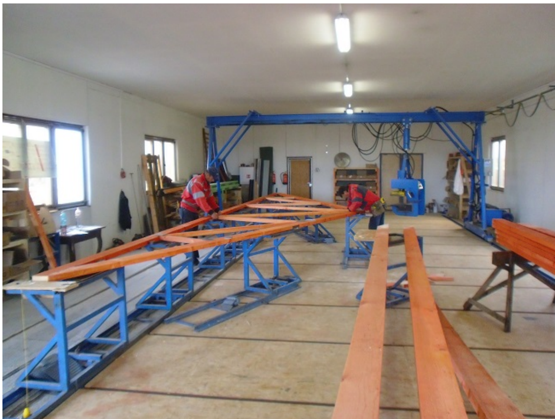
Obrázek 14. Výrobní prostory pro sestavení a zalisování vazníků pro RD Čejkovice
