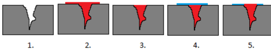
Obr. 3 - Postup zkoušení kapilární metodou
