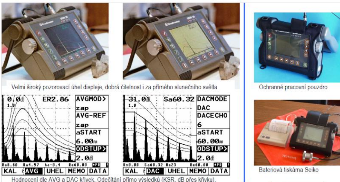
Obr. 21 - Novější digitální defektoskop USM 35X S [11]
