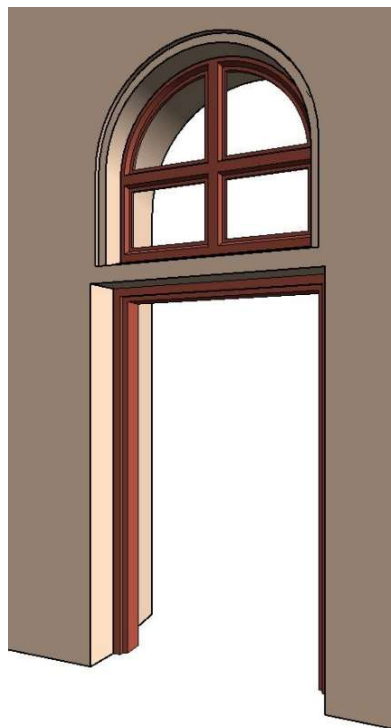
Obr. 27: Konstrukce zárubeň a rámu
