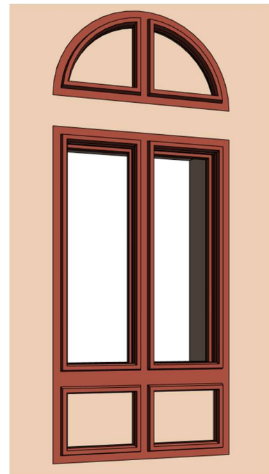
Obr. 23: Konstrukce okenních křídel
