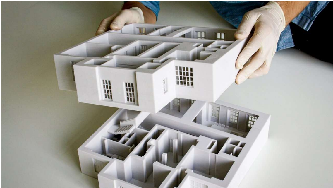
Obr. 50: Použití 3D tisku na modelech podlaží budovy [42]
