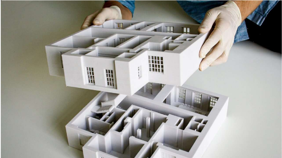
Obr. 50: Použití 3D tisku na modelech podlaží budovy [42]
