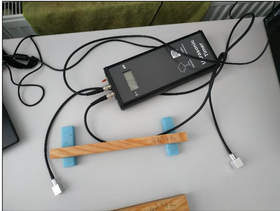
Obrázek 18 Metoda měření ultrazvuku Fakopp
