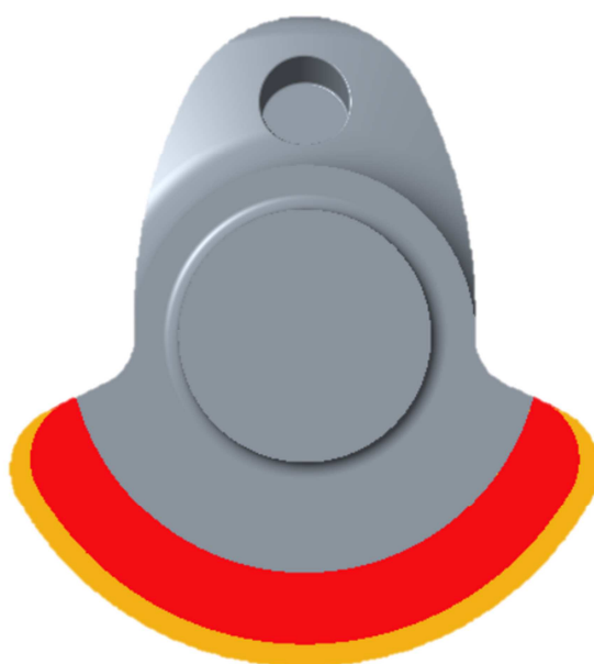
Obr. 31 Vývažek momentů setrvačných sil posuvných částí I. řádu (žlutě)
