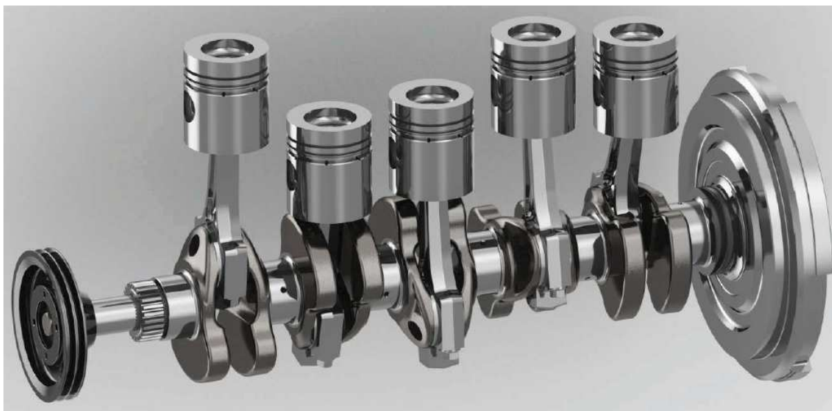
Obr. 1 Klikový mechanismus pětiválcového řadového motoru [14]
