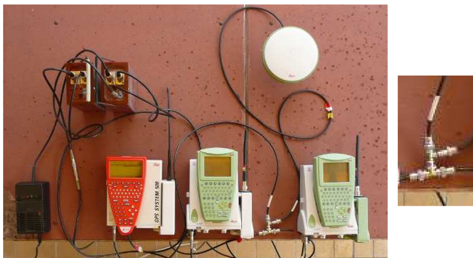
Obr. 10 – a) zapojení GNSS aparatur, b) anténní rozdělovač signálu
