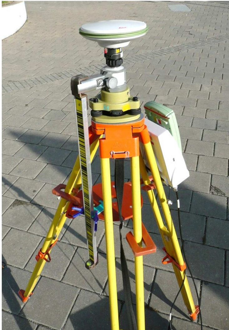
Obr. 26 – GNSS aparatura se závěsnou latí při měření
