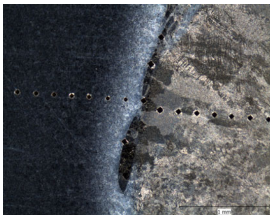
Obr. 11.6 Svarové rozhraní P91/P22 600 °C/15875 h Makro (leptáno - Nital).
