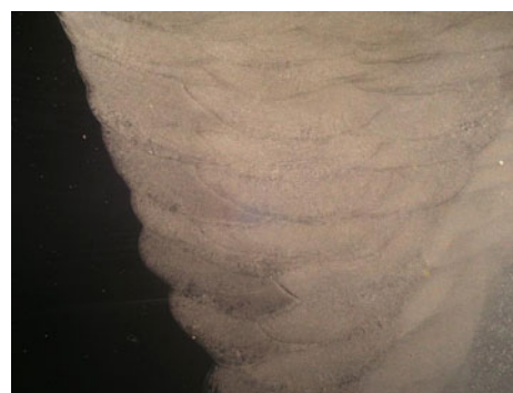
Obr. 7.1b Detail návarových housenek uzavíracího svaru OK13.43 (leptáno - Nital).
