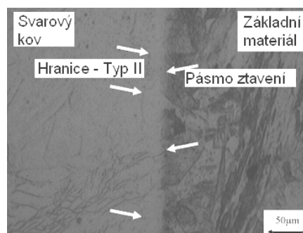
Obr. 3.3a Oblasti HAZ svarového spoje [58]. Obr. 3.3b PZ svarového spoje [59].
