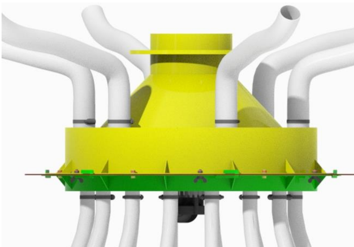
obr. 11.1 Přední pohled na výsevní mechanismus.
