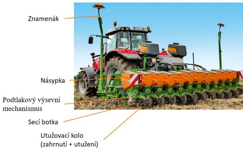
obr. 3.15 Secí stroj pro přesný řádkový výsev [6].
