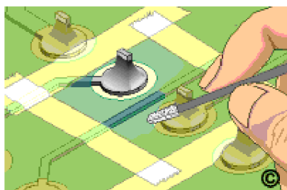
Obr. 9: Použití rozpouštědla s pěnou [3]
