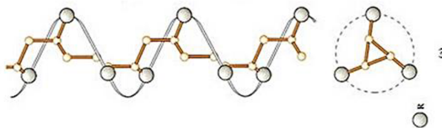
Obr. 3: Schéma konformační uspořádání 3/1 helixu i-PP [8].
