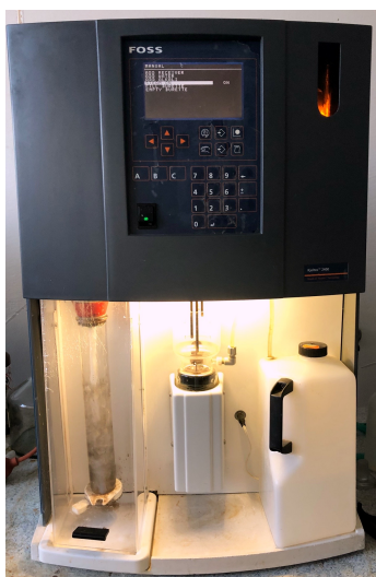
Obrázek 10: Přístroj Kjeltec v průběhu analýzy
