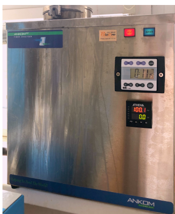
Obrázek 11: Analyzátor vlákniny ANKOM 200 v průběhu analýzy
