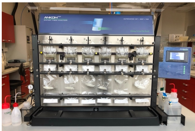
Obrázek 9: Analyzátor vlákniny ANKOM Dietary Fiber Analyzer v průběhu analýzy
