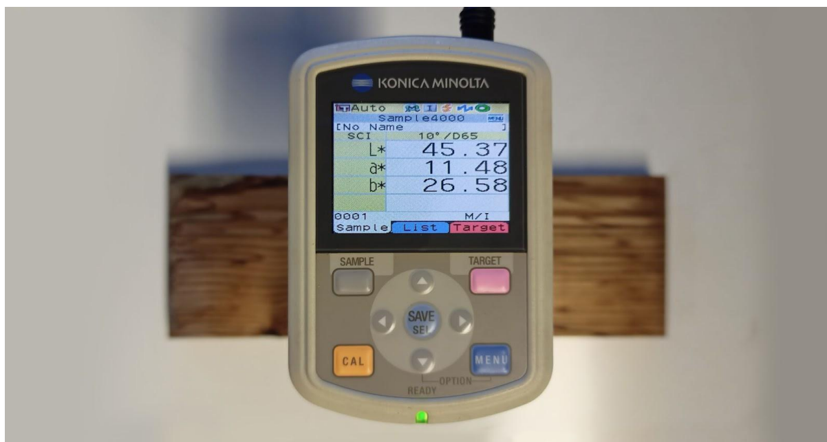
Obrázok č. 4. Meranie farby spektrofotometrom VTL CM-600D určujúcim farbu pomocou L^*a^*b diagramu (vlastné)
