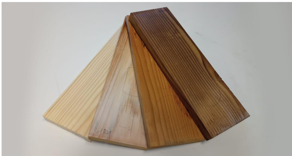
Obrázok č. 6. Porovnanie vizuálu rôzne upravených vzoriek. Zľava (bez tepelnej úpravy pred starnutím, bez tepelnej úpravy po starnutí, tepelná úprava pri 180 °C po starnutí, tepelná úprava pri 200 °C po starnutí (vlastné))
