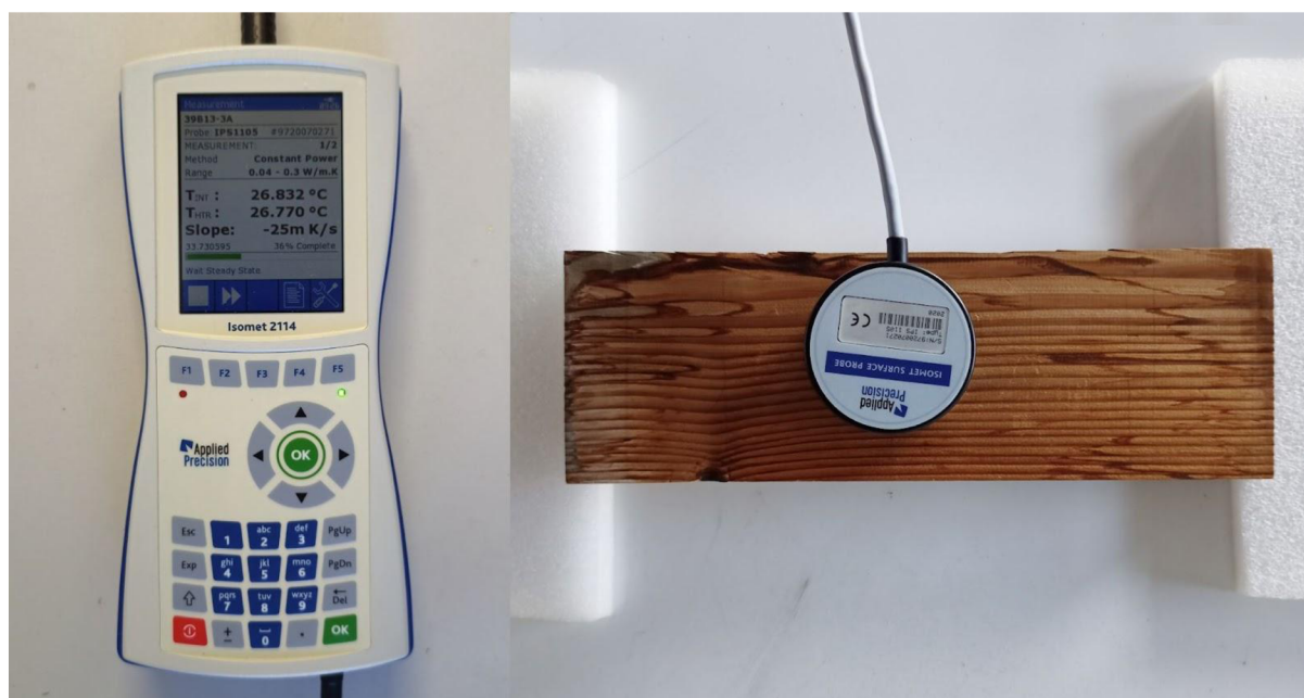
Obrázok č. 5. ISOMET 2114 použitý na meranie tepelných charakteristík (vlastné)
