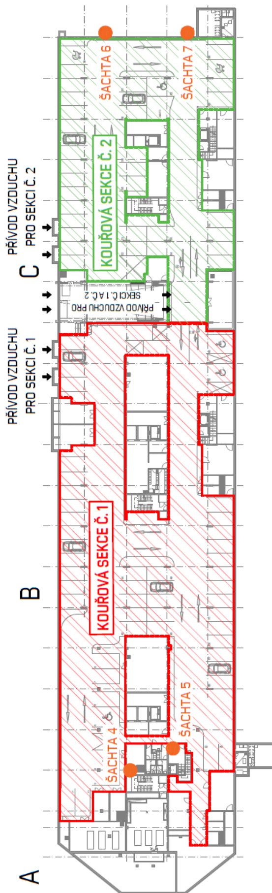
Obrázek 20 – Přívod a odvod vzduchu
