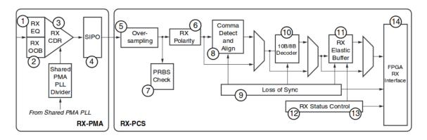
Fig. 5.3: GTP RX Block Diagram[28]
