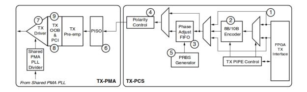
Fig. 5.2: GTP TX Block Diagram[28]
