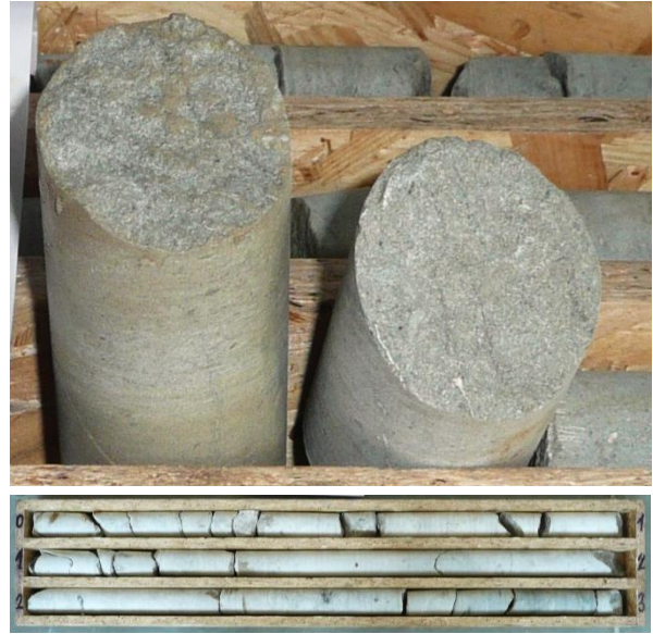
Obr.25 Vrtná jádra a vzorkovnice dl. 1 m (archiv autora)
