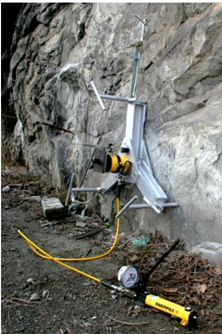
Obr.22 ENERPAC 600 a zatěžovací stend (archiv autora)
