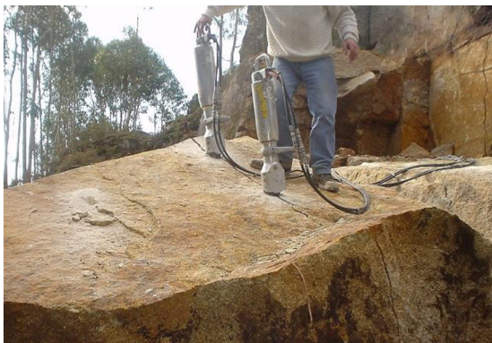
Obr.12 Hydraulické trhací klíny s tlakem až 365 t (www.darda.de)
