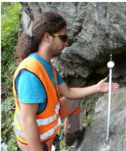
Obr.6 1D dilatometr podle vlastního návrhu (sada kalibrovaných nastavitelných tyčí s roztečí 20 až 270 cm a měřicím rozsahem \pm 15 mm s přesností měření 0,01 mm (archiv autora)
