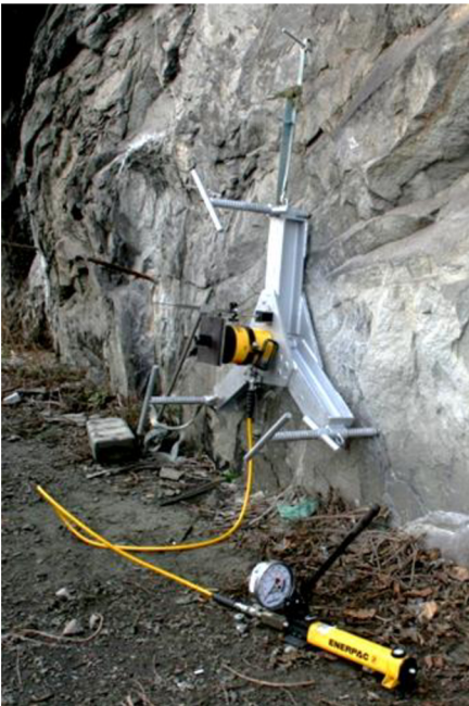
Obr.22 ENERPAC 600 a zatěžovací stend (archiv autora)
