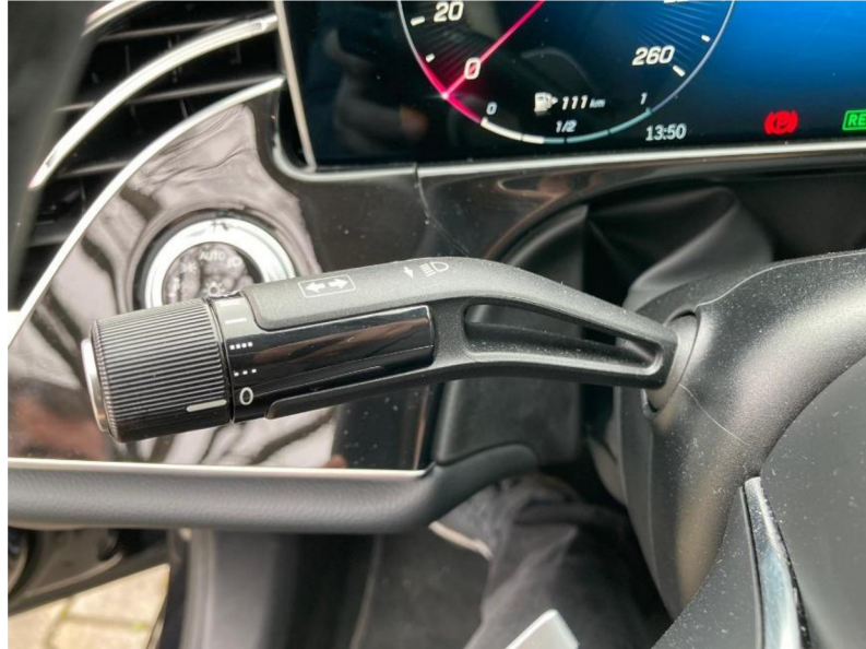
Obrázek 36 - Ovládání stěračů, ostříkovačů, dálkových světel a směrových ukazatelů 214 [20]
