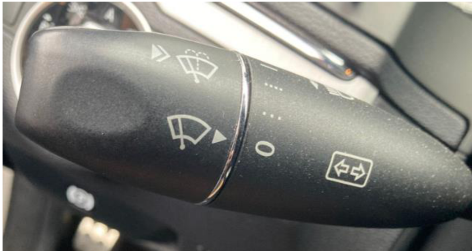
Obrázek 34 - Ovládání stěračů, ostřikovačů, dálkových světel a směrových ukazatelů 212 [20]
