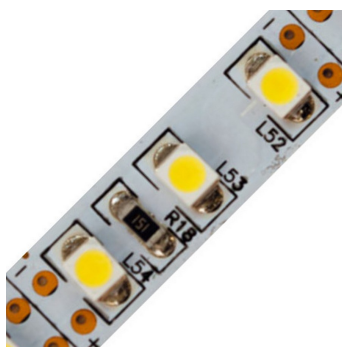
Obr. 7.2: Ilustrační obrázek uspořádání prvků na Led pásku[38].
