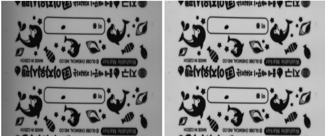
Obr. 7.3: V levo snímek bez kompenzace nerovnoměrného osvětlení, v pravo snímek s kompenzací nerovnoměrnosti osvětlení
