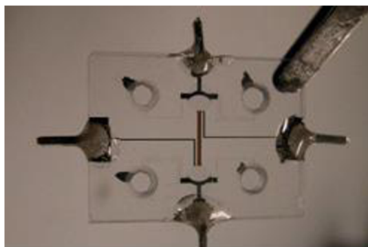
Obrázek 5: Skleněný mikrofluidní čip [7]
