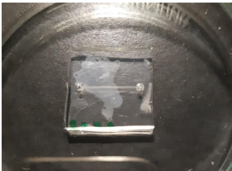
Obrázek 11: Slepený PDMS čip s viditelnou strukturou kanálek v Petriho misce podložený černým papírem. V levé části čipu se nachází světlá šedá skvrna, která je tvořena vzduchovou bublinou uzavřenou mezi krycím sklíčkem a polymerem.
