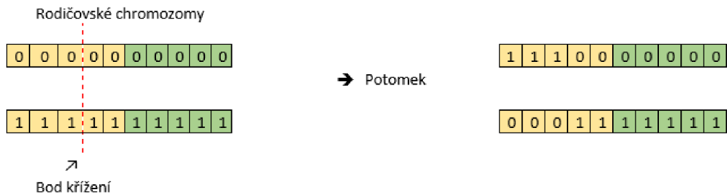
Obrázek 3 Jednobodové křížení Zdroj: [18]
