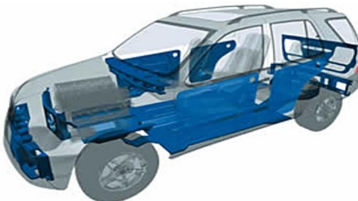
Obrázek 13 - Příklad použití dílců z vyztužených termoplastů v automobilu [32]
