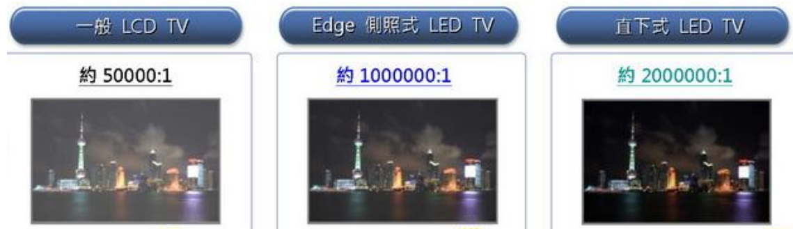
Obrázek 4 - Porovnání kontrastu u různých druhů LCD TV (LCD, Edge LED a Direct LED)
