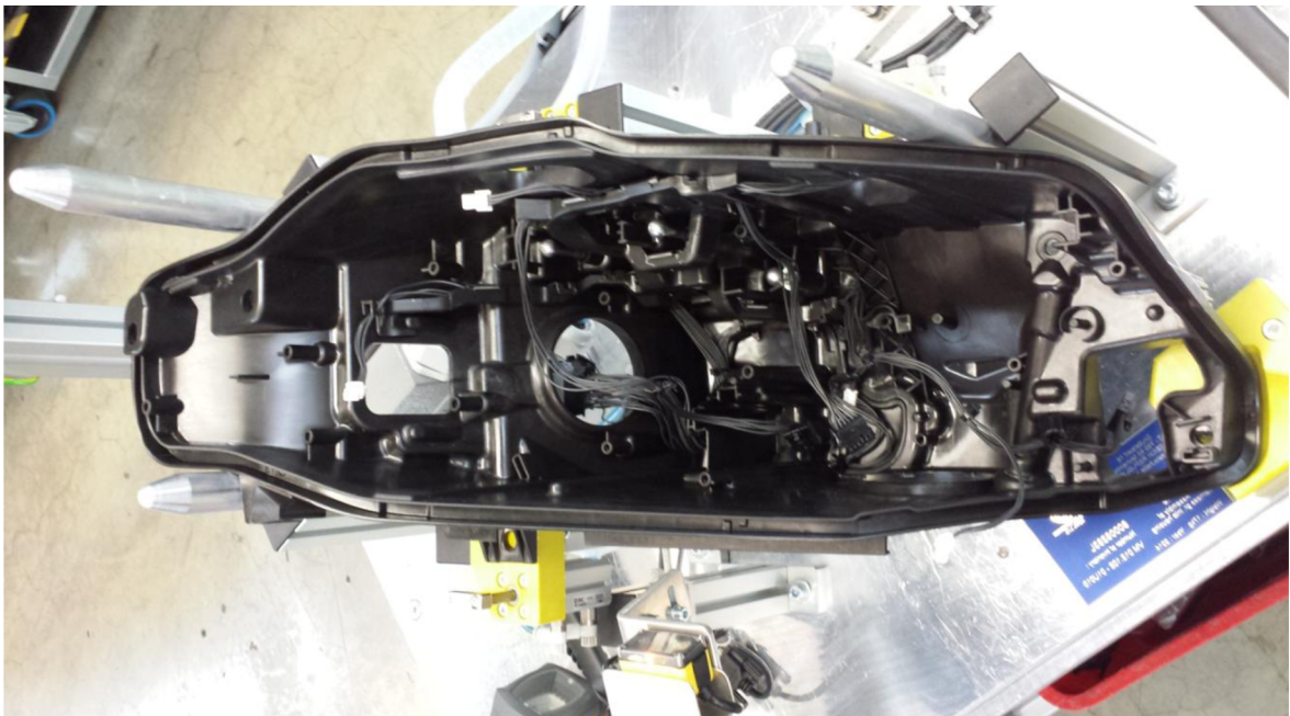
Obr. 4.3 Ruční pracoviště – trasování vodičů [18].
