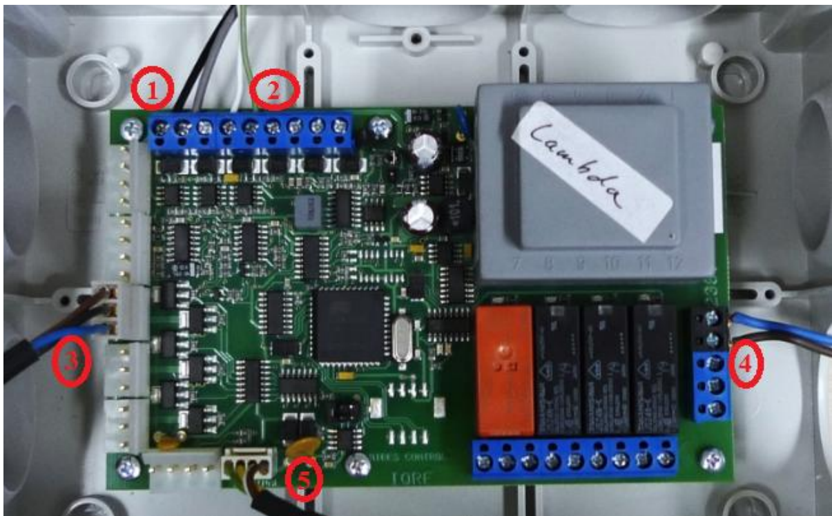
Obrázek 4.4: Zapojení regulace Reg310
