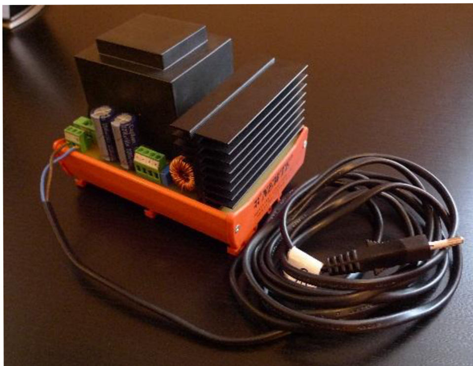
Obrázek 3.3: Napájecí zdroj lambda sondy
