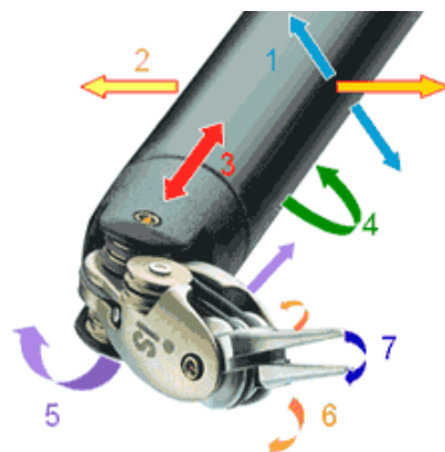
Obr. 1.8: Možné pohyby nástrojovej hlavy
