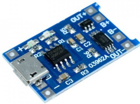
(a) Nabíječka Li-ion článku TP4056 [23]
