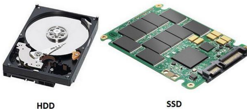
Obrázek č. 13 – srovnání SSD a HDD (37)
