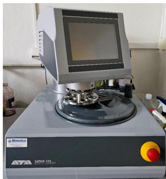
Obr. 21 Automatická jednokotoučová bruska / leštička Saphir 550
