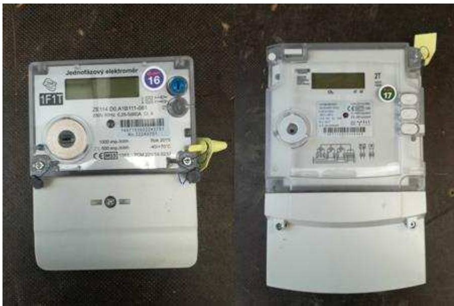
Obrázek 3 - Jednofázový a třífázový dvoutarifní elektroměr
