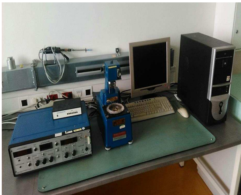
Obr. 5-6: Měřicí stanice s meniskografem
